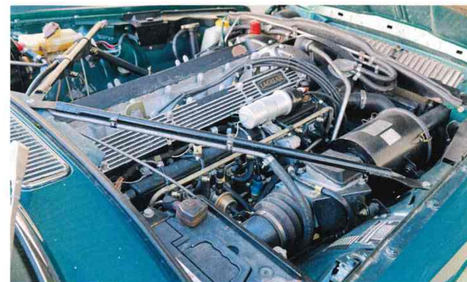
Langhubiger XK-Sechszylinder mit zwei Nockenwellen und Bosch L-Jetronic. Kesser Augenaufschlag wie bei den technisch sehr ähnlichen Vorgängern Mark X und S-Type.
