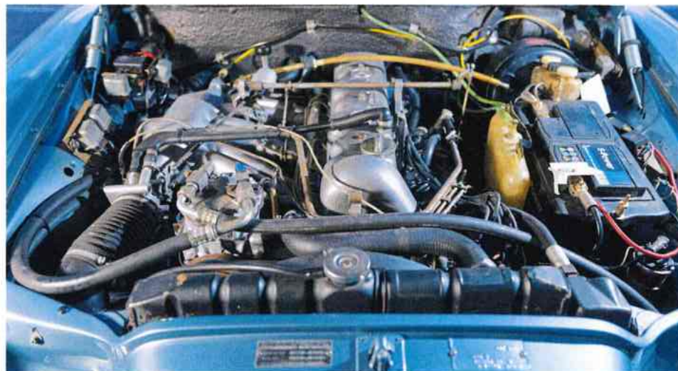
Sechszylinder-Einspritzmotor Typ M 130 mit obenliegender Nockenwelle und sieben Kurbelwellenlagern. Zwischenpolster sind ideal mit Automatik-Wählhebel am Lenkrad
